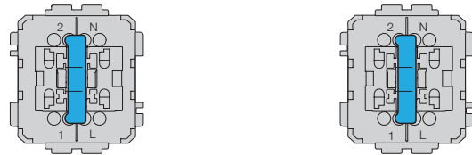
Рис 5: Подсветка в положении «ВЫКЛ.» (ориентирующая подсветка), схема перекрестного включения с 2 выключателями/переключателями с подсветкой, с линзой, контакт светодиода на зажимах 2—1
