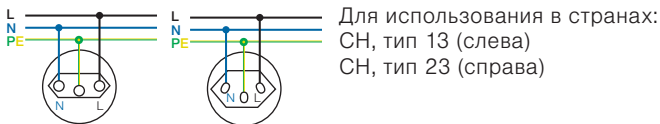
Рис. 4. Розетка с защитным контактом «ШВЕЙЦАРИЯ» с 2 полюсами + заземление, тип 13: 250 В~, 10 А; тип 23: 250 В~, 16 А
