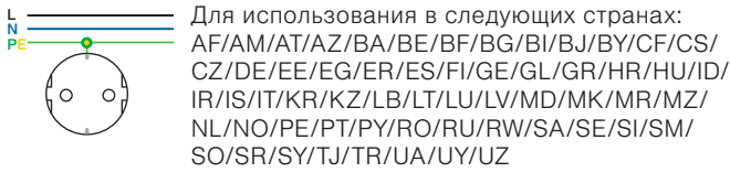
Рис. 1. Розетка SCHUKO* с 2 полюсами + заземление, 250 В~, 16 А
