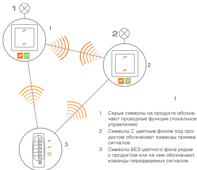
Рис 3: Пример конфигурации передатчик/приемник
