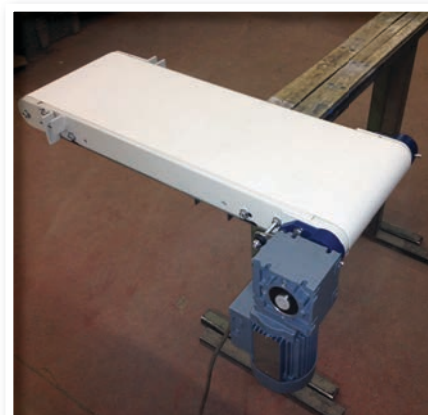
Convoyeurs faible encombrement, tambour Ø60
