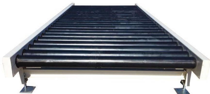
Le convoyeur palette à rouleaux motorisés est spécialement adapté pour la manutention de palette et autres charges...
