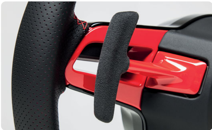
TECHART Individualität im Detail: perforiertes schwarzes Nappaleder, darunter ein Zuspanntuch in rot, passend zur Ziernaht. Lenkradblenden und Schaltpaddles in rot/schwarz lackiert. Paddle-Rückseite in Alcantara. TECHART Individuality in detail: perforated black Nappa Leather, with a red backing, perfectly matching the red stitching. All trims and paddle shifters lacquered in gloss red/black. Paddle trims in Alcantara.
