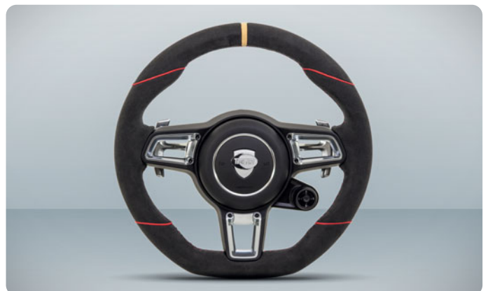
Typ 7 mit Mode-Schalter. Zierbiesen in rot, Kranz in Alcantara mit gelber 12-Uhr-Markierung. Type 7 with Mode Switch. Leather piping in red, rim in Alcantara with yellow straight-ahead-marker.
