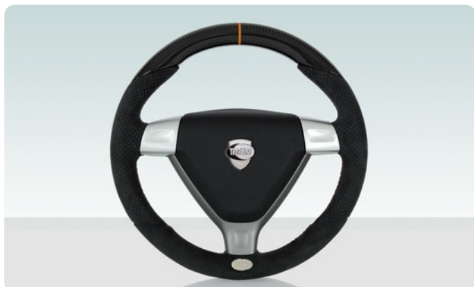
Typ 1 in Alcantara schwarz, oberes Segment aus Carbon mit einlackierter 12-Uhr-Markierung. Type 1 in black Alcantara, rim segment in carbon fiber with painted straight-ahead-marker.
