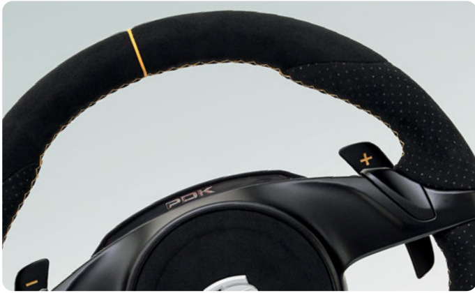
12-Uhr-Markierung in Form einer schmalen Lederbiese, kombiniert mit Alcantara. Straight-ahead-marker made of a thin leather piping, combined with Alcantara.
