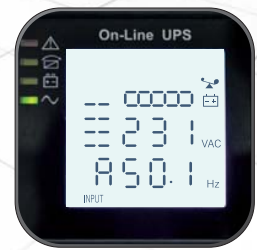
Панель керування силового модуля
