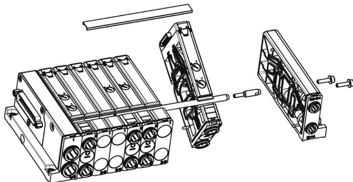
Grazie ad una clip di fissaggio è possibile sostituire le boccole di collegamento alle tubazioni. Le possibilità variano in base al passo e sono: Ø4, Ø6 e Ø8 per le elettrovalvole e Ø8, Ø10 per l'alimentazione e lo scarico.
