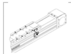
Comprende: - 1 Sensor dog - 2 viti per sensor dog - 1 piastra supporto sensore - 2 viti piastra supporto sensore - 2 dadi per cava
