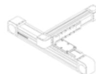
Comprende: - 1 piastra d'interfaccia - 8 viti e 8 rosette di sicurezza per asse principale - viti e dadi per cava per collegamento asse secondario
