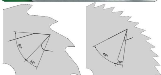
**PZ-010** для продольной распиловки      **PZ-110** для поперечной распиловки
