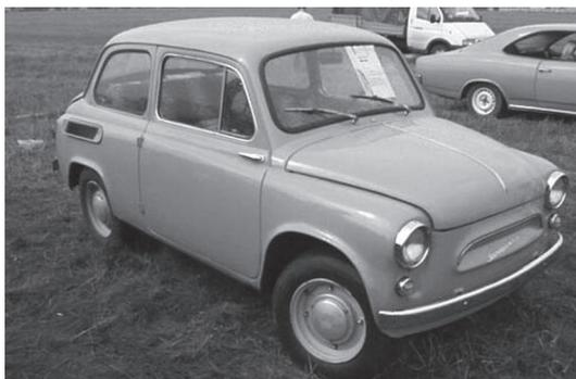
А в конце года, 28 декабря, на Запорожском автомобильном заводе был изготовлен первый отечественный малолитражный автомобиль ЗАЗ-965 «Запорожец». Он весил всего 665 кг, обладал хорошей проходимостью, благодаря независимой подвеске всех колес, и был хорошо приспособлен для грунтовых и проселочных дорог. Толь-
