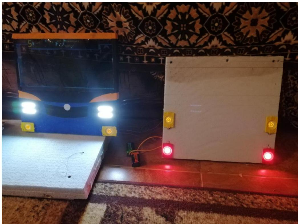
Для проводки використали провід марки ПВ1Х1,5
