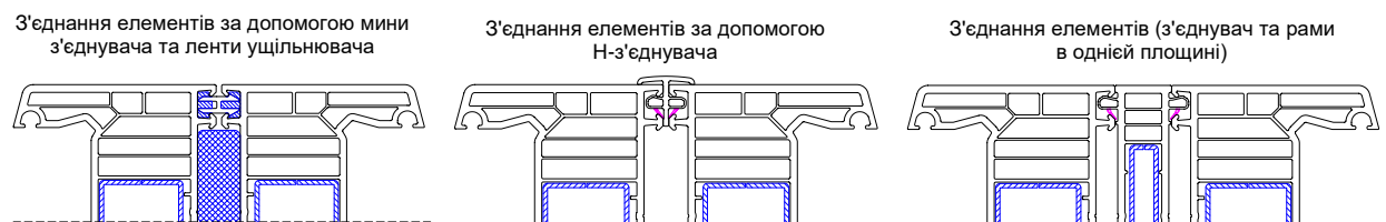
Рис. 4.7: Утворення з'єднань механічно міцно змонтованих елементів
