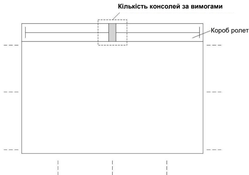
Рис 3.6: Представлення широкоформатної ролетної системи з використанням опорної консолі
