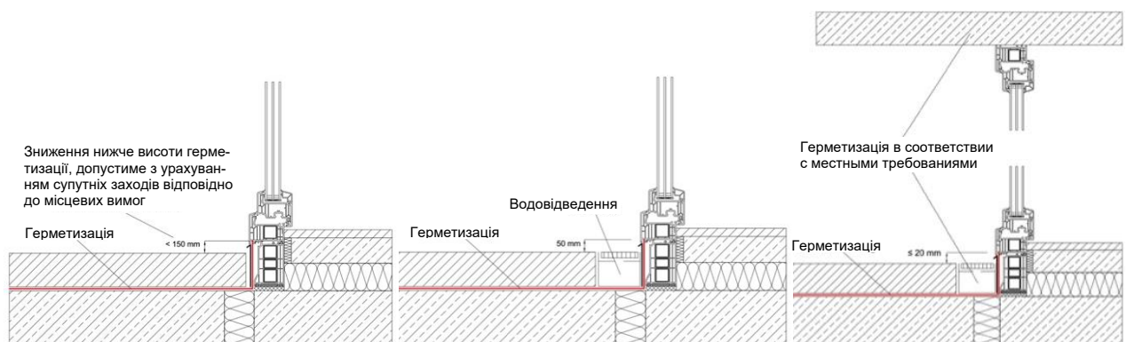
Рис. 4.10: Зниження нижче висоти герметизації (ліворуч), висота герметизації в нижній частині плоского даху (посередині), висота герметизації в нижній частині дверних розширювачів і порогів для безбар'єрної конструкції (праворуч)
