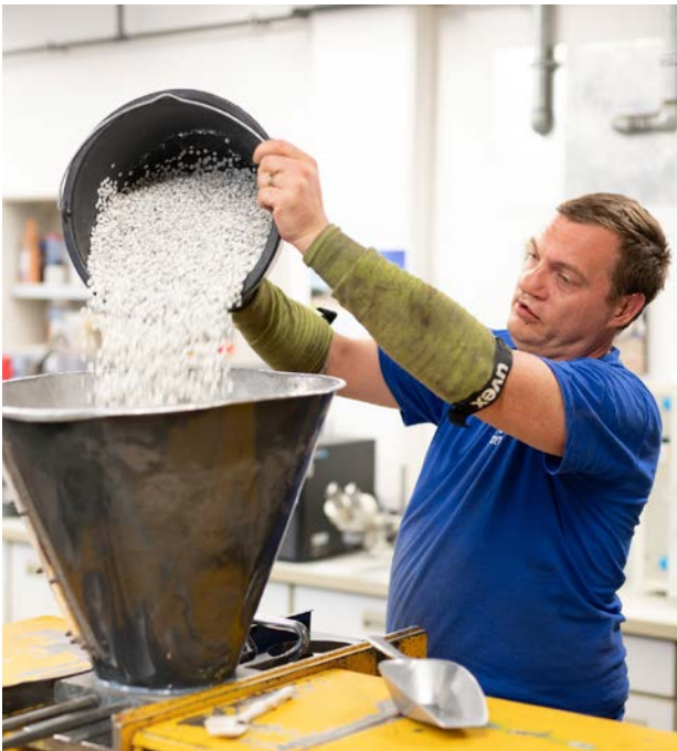
Працівник засипає подрібнений ПВХ. Надалі із вторсировини виготовлять новий ПВХ. Фото: Christopher Schmid
