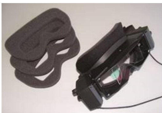
Рис. 2.6-2: Маска з боковими камерами із знімною кришкою (ліворуч) та знімні одноразові пінопластові прокладки (праворуч)
