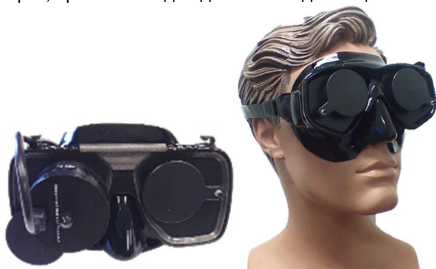
Рис. 2.6-6: Стандартна маска з верхньою камерою (ліворуч) і маска з передньою камерою маленького розміру (праворуч)
