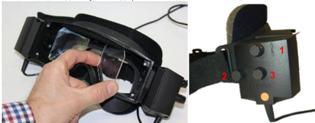
Рис. 2.6-4: Регульовані ІЧ дзеркала для прилаштування відстані між зіницями (ліворуч) та ручки для 1) вертикального регулювання камери, 2) горизонтального регулювання камери, 3) фокусування камери (праворуч)
