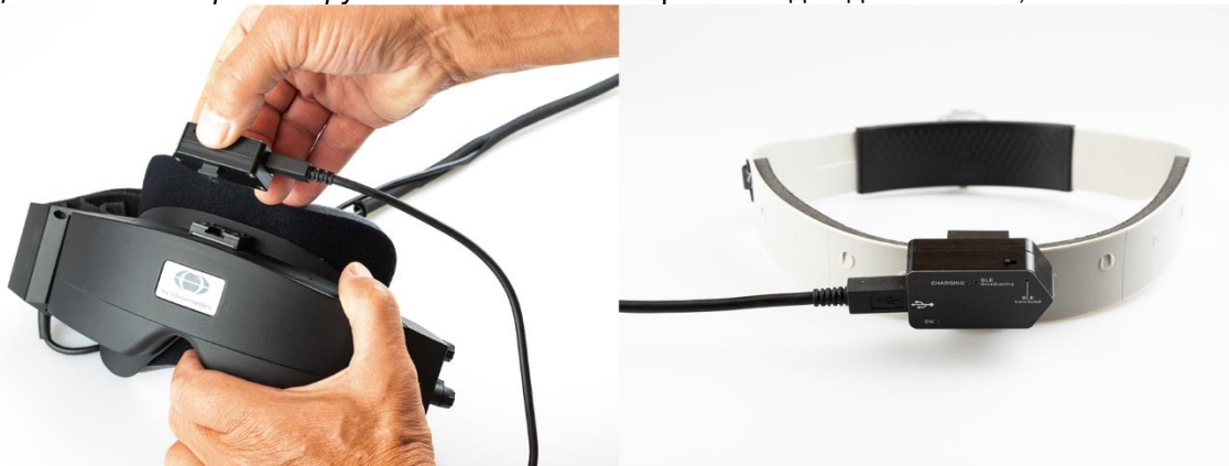
Рис. 2.6-17: Кріплення VORTEQ™ 2 ге покоління IMU на масці з бічними камерами (ліворуч) та зображення прикріпленого на оголів'я датчика для тесту Динамічної гостроти зору (праворуч)
