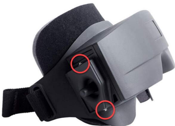
Рис. 2.6-3: Шестигранні фіксуючі гвинти у верхній і нижній частинах маски з боковими камерами, що використовуються для фіксації камери або кришки (на рисунку)
