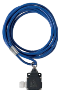
Вимикач із тяговим шнуром Може монтуватися горизонтально або вертикально, корпус із литого під тиском алюмінію, IP 65, довжина кабелю 4 м
