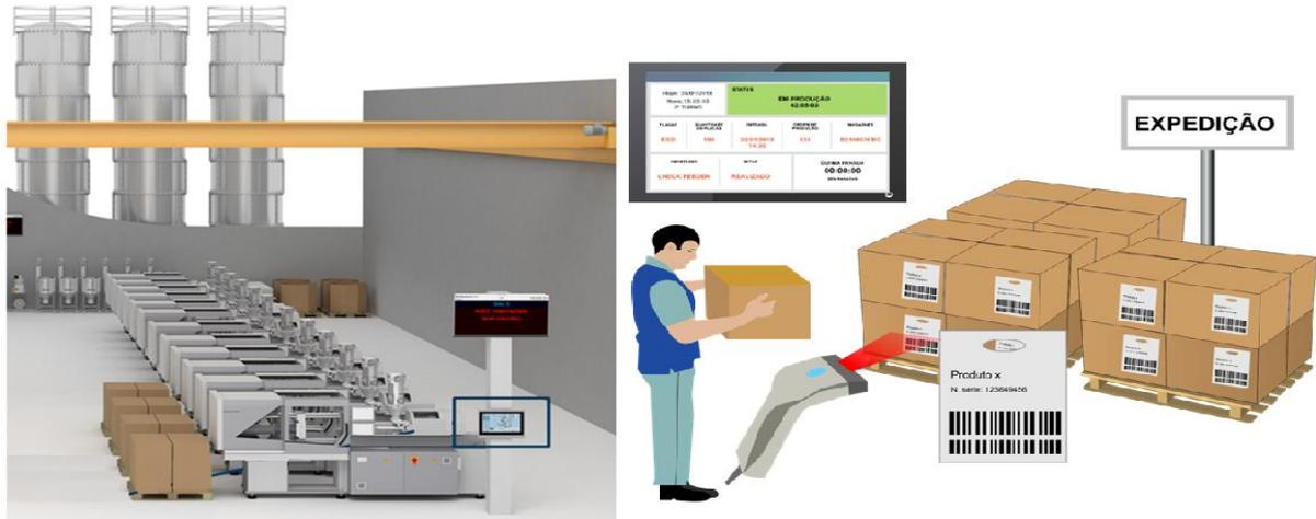
Os transportadores automáticos (ex: esteiras, AVG e outros) possuem sistemas computacionais embarcados de controle que se conectam na rede industrial de dados, e são programados para transportar a quantidade planejada. Outrossim, as matérias primas e os produtos semielaborados, bem como os contêiner de armazenagem, possuem código de barras ou etiquetas RFID para determinar sua localização e movimentação. O sistema gerencia o inventário em tempo real da produção, WIP.
