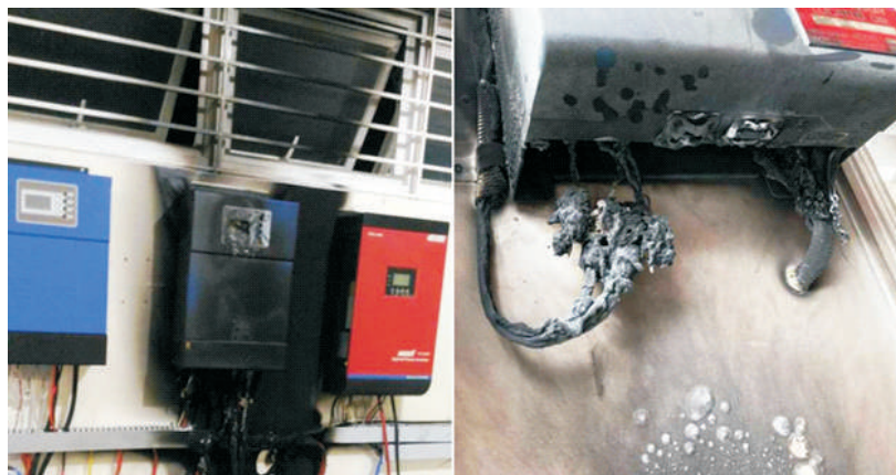
Фото 1. Результат дії перенапруги, викликаній блискавкою.
