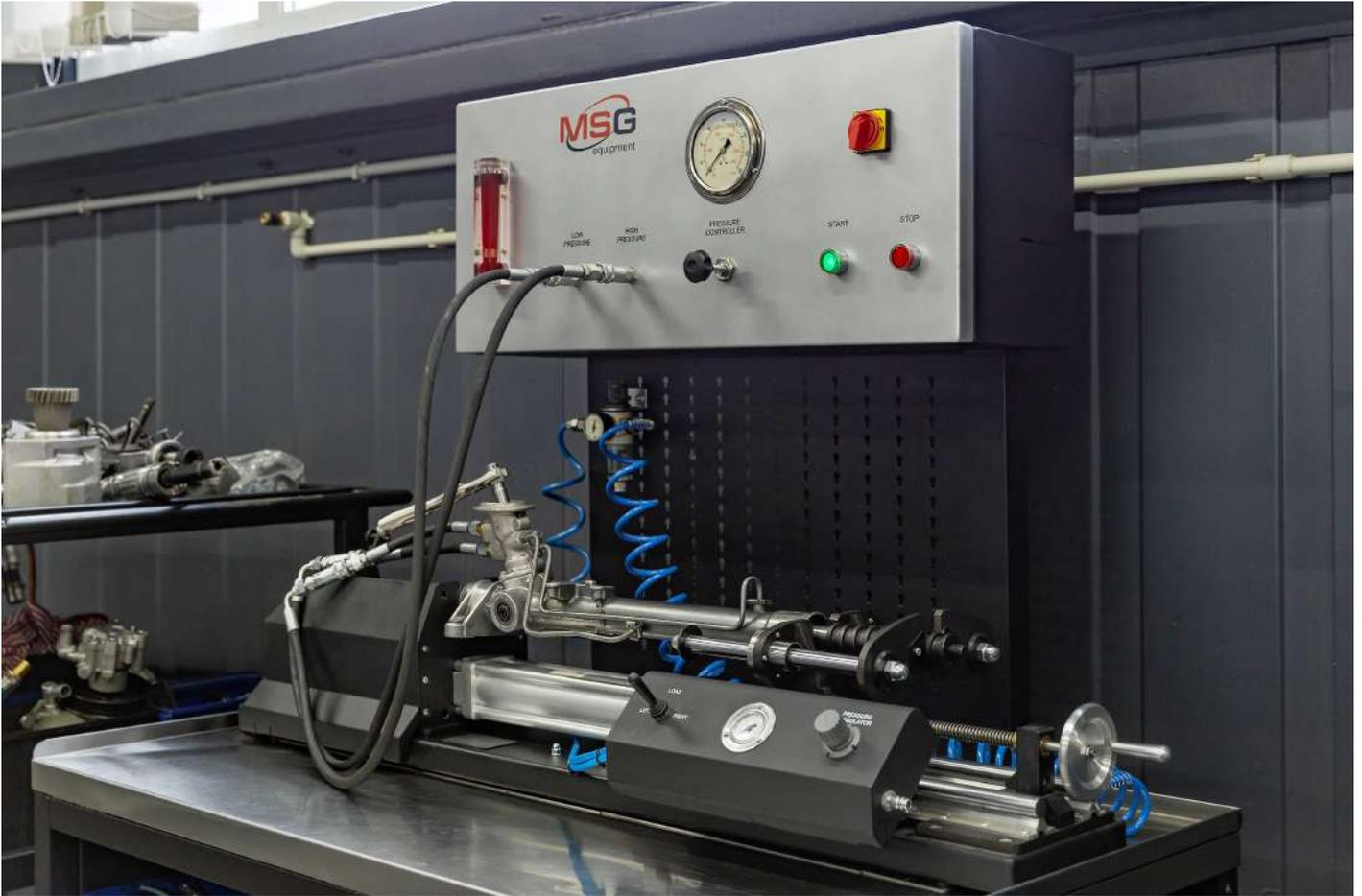
El banco de pruebas MS502M se utiliza para el diagnóstico de las cremalleras de dirección asistida hidráulica. El banco de pruebas simula el funcionamiento de la unidad en el vehículo, lo que permite determinar la presencia del fallo y su naturaleza.
