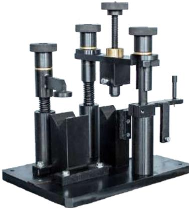
El sistema de llenado de gas para amortiguadores **MS200** se utiliza durante la reparación y el mantenimiento de los amortiguadores automotrices como equipo especializado y se coloca en el banco de trabajo del cerrajero. El sistema MS200 puede utilizarse para llenar amortiguadores con una presión (de trabajo) de hasta 120 bares.
