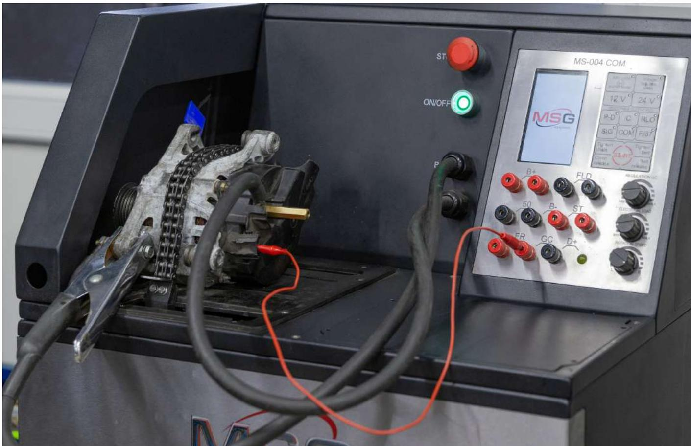
El banco de pruebas MS004 COM permite evaluar el estado técnico de los alternadores con una carga admisible de hasta 100 A para 12 V y de hasta 50 A para 24 V, de los motores de arranque de 12 V /24 V con potencia de hasta 4 kW y todos los relés reguladores modernos. Los parámetros del banco de pruebas permiten diagnosticar los alternadores y motores de arranque en coches y camiones ligeros, así como realizar pruebas de control en las unidades tras su reparación.
