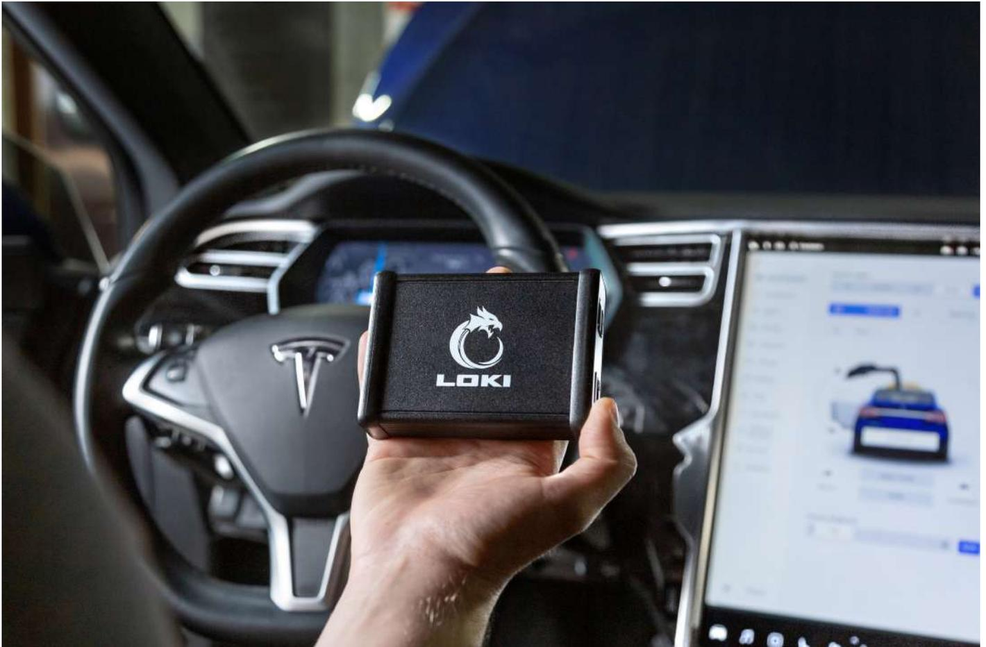
LOKI está diseñado para que cualquier taller pueda realizar una gama completa de servicios de diagnóstico, mantenimiento y reparación de toda la gama de los vehículos Tesla
