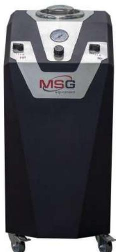
La estación MS101P se utiliza durante el mantenimiento o reparación del sistema de climatización automotriz. La estación proporciona un lavado de alta calidad de las tuberías y componentes del sistema con un flujo pulsante del líquido de lavado. Después del lavado, la estación permite eliminar el líquido de lavado restante del sistema con nitrógeno, que se conecta previamente a la estación.
