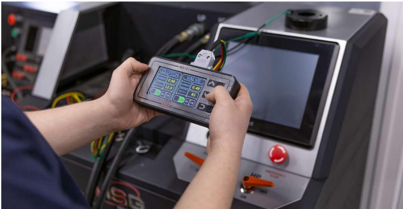
El probador MS121 es un dispositivo compacto que combina la capacidad de probar tanto los embragues electromagnéticos como las válvulas de control de los compresores de sistemas de climatización automotrices.
