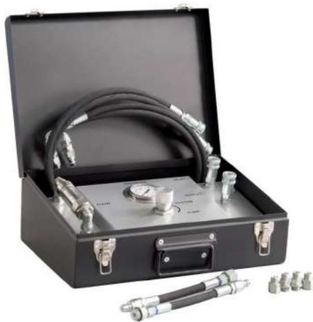
El probador MS611 está diseñado para diagnosticar los componentes de dirección asistida hidráulica: bomba y cremallera en el vehículo sin desmontar las unidades. El probador permite determinar el estado técnico de las unidades y retirarlas del vehículo para su reparación si es necesario.
