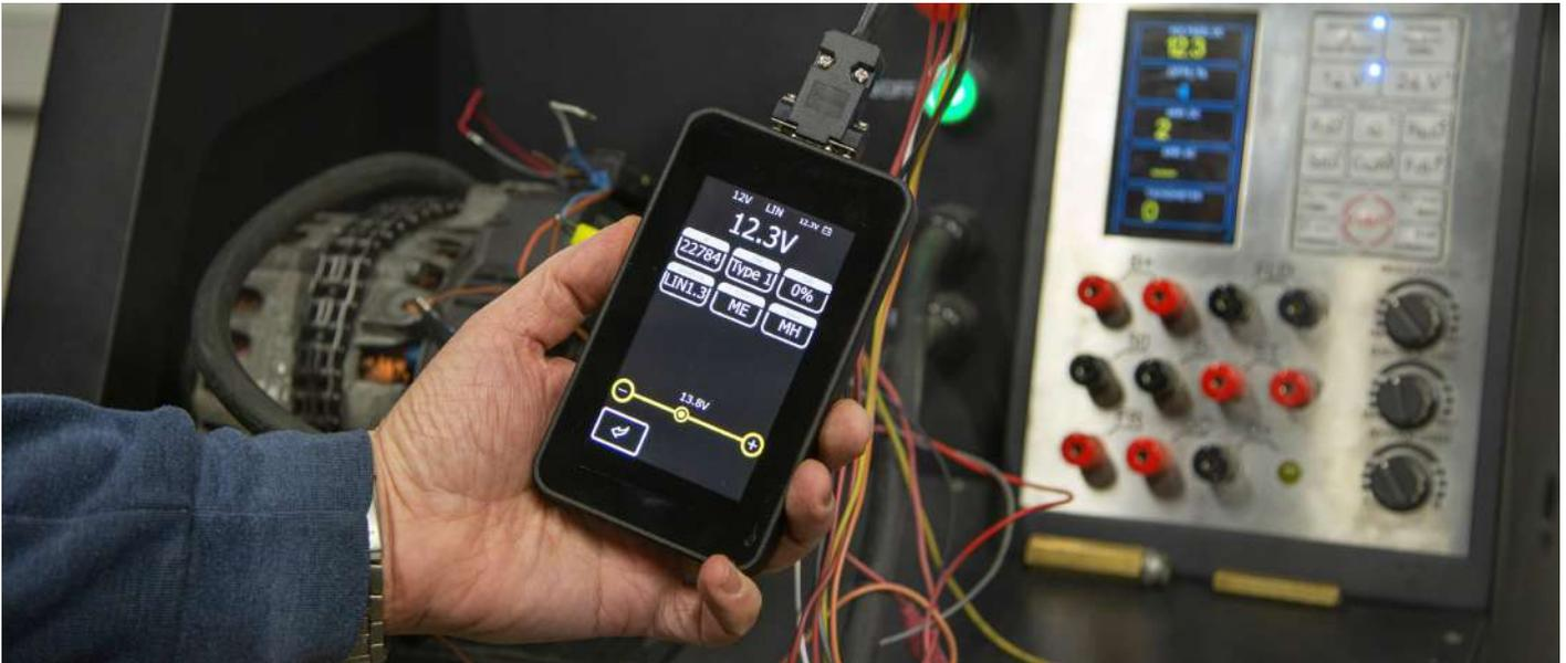
El probador MS016 es un dispositivo multifuncional compacto diseñado para el diagnóstico rápido de los alternadores automotrices de 12/24 V, de los alternadores con sistema Start-Stop de 12 V y de los motores de arranque directamente en el coche. El probador permite evaluar la funcionalidad de los reguladores de tensión, independientemente del alternador, así como leer y almacenar los datos transmitidos a través del bus LIN del vehículo.
