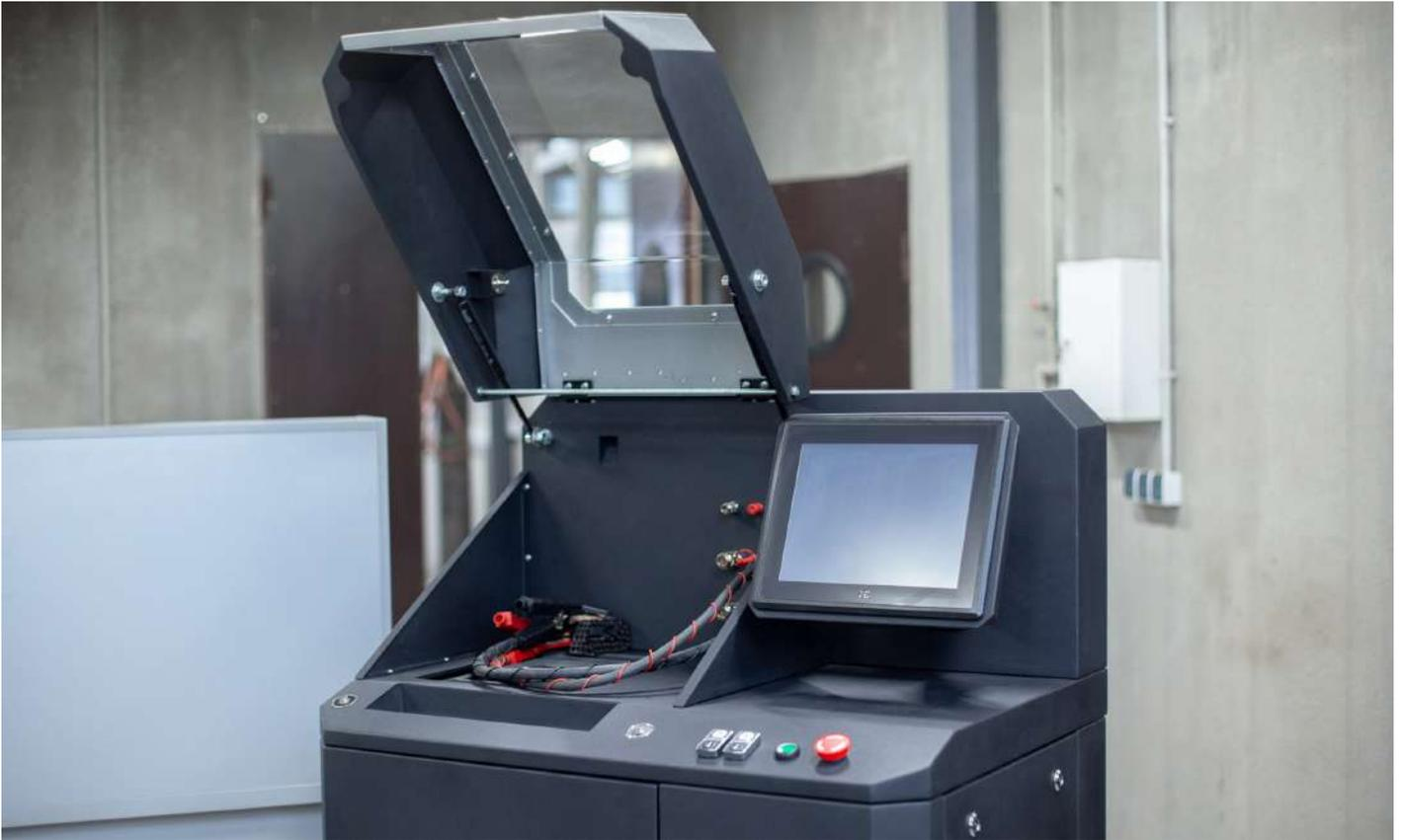
**MS005** es un banco de pruebas multifuncional diseñado para el diagnóstico rápido y preciso de los alternadores y motores de arranque en coches y camiones de carga pesada.
