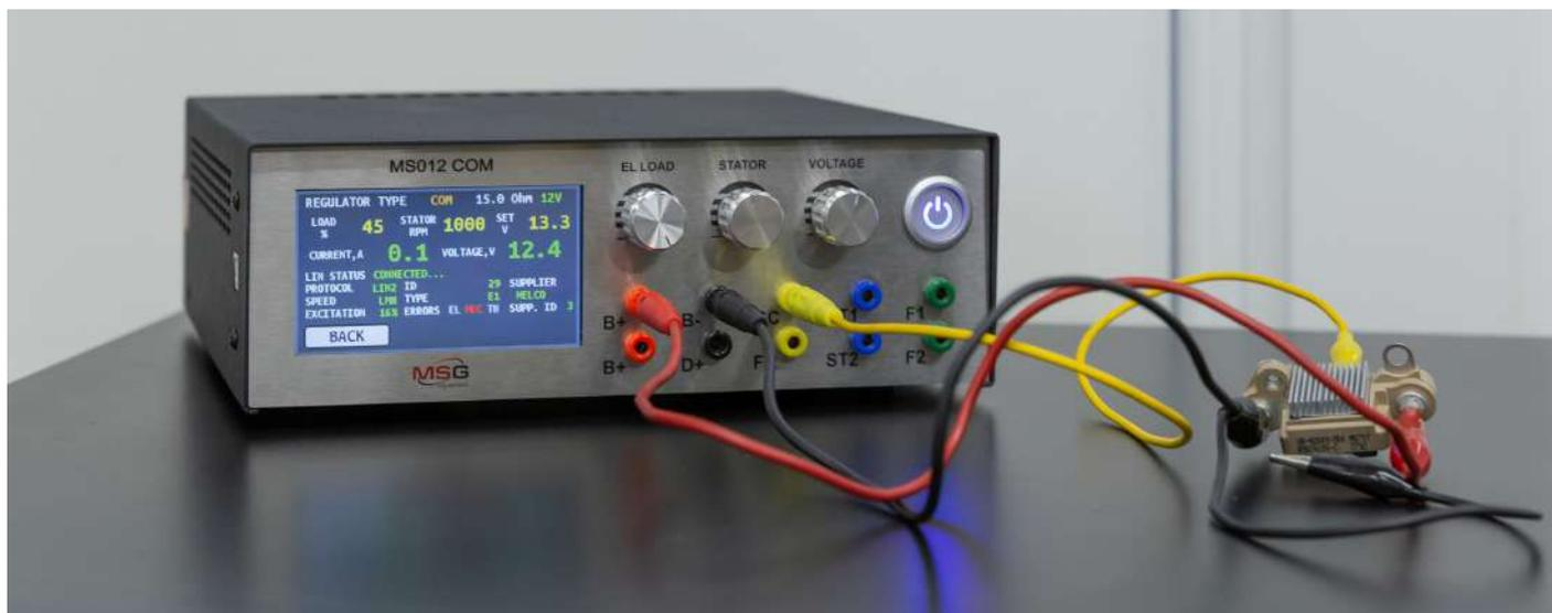
El probador MS012 COM simula un alternador en buen estado para el regulador de tensión, lo que permite evaluar bien su funcionalidad, así como elegir un regulador sustituto.
