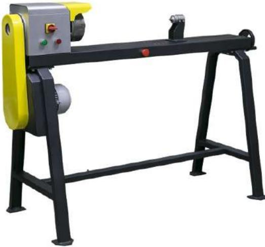
**Máquina pulidora MS402** está diseñada para el rectificado y pulido de diversos ejes, barras de cremalleras de dirección y otros productos con el fin de eliminar la corrosión y obtener la rugosidad superficial requerida.
