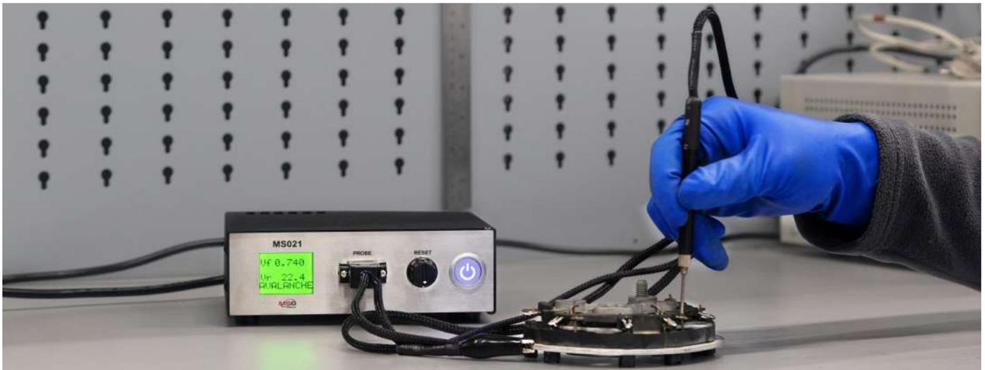
El probador MS021 proporciona un diagnóstico fiable del estado técnico del puente rectificador o del diodo separadamente. El probador determina el tipo y las características del diodo, informa sobre el tipo de fallo y puede detectar la degradación de diodos.
