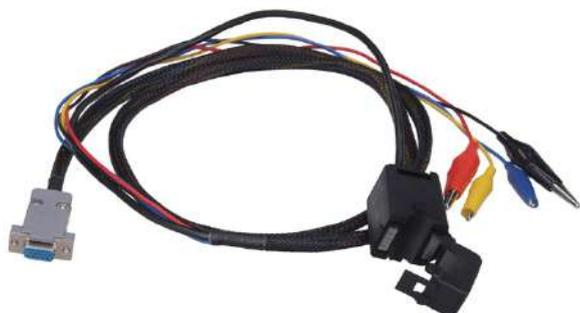
El probador MS016 y el cable MS-33503 permiten registrar los valores de tensión en los terminales del motor de arranque: 31, 30, 50, 45 y la corriente en el terminal 30 durante el arranque del motor. El resultado de las mediciones realizadas se muestra en la pantalla del probador en forma de gráfico. Además, se muestran numéricamente los valores mínimos y máximos de los parámetros medidos. Esta información permite detectar anomalías en el motor de arranque, en la batería o en el cableado.
