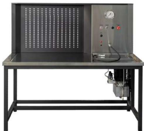
El banco de pruebas MS300 está diseñado para diagnosticar y reparar las pinzas de freno. Permite determinar la funcionalidad y estanqueidad de las unidades. Está prevista la posibilidad de diagnosticar el funcionamiento del actuador electromecánico del freno de estacionamiento.
