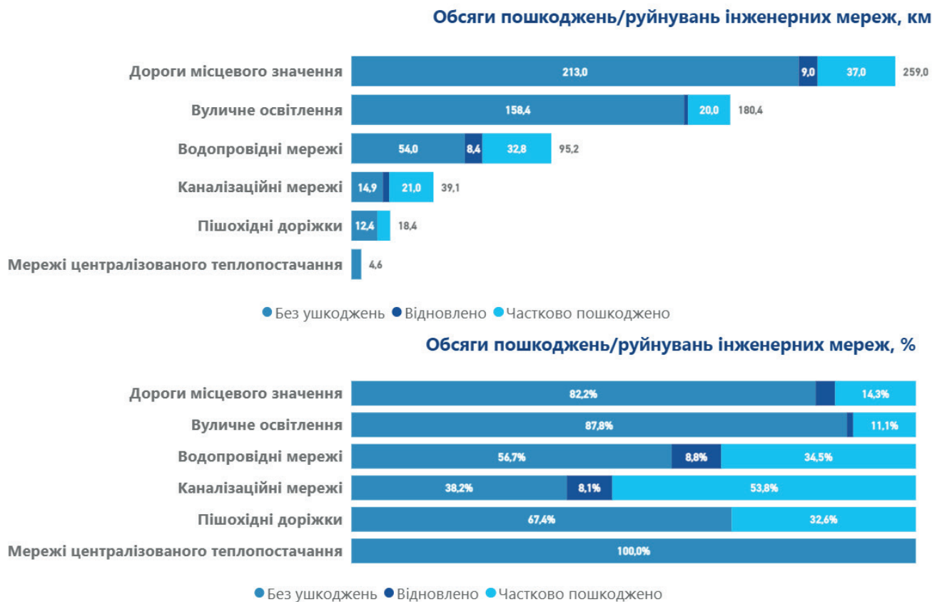
Рисунок 31. Обсяги пошкоджень/руйнувань інженерних мереж, км, %
