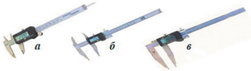
Рис. 3.5.8. Штангенциркулі: а — ШЦ-I; б — ШЦ-II; в — ШЦ-III
