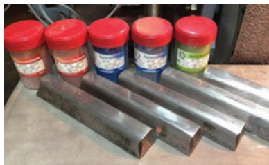
Рис. 1.10.7. Комплект для ручного притирання, що складається з чавунних притирів і алмазної пасті різної зернистості
