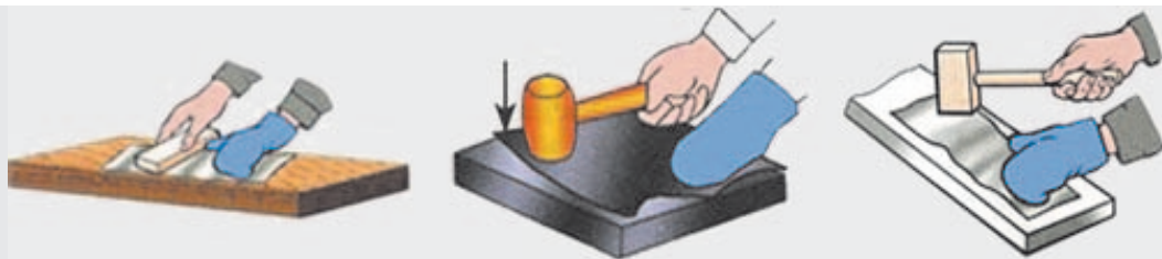
Рис. 1.3.1. Правка тонкого листового металу
