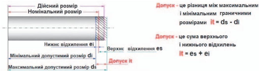
Рис. 3.2.3. Розміри деталі, відхилення та допуск
