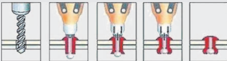
Рис. 1.8.15. Схема прийомів з'єднання деталей витяжною заклепкою
