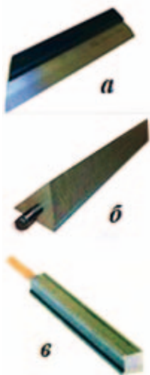
Рис. 3.5.4. Лекальна лінійка: а — з двостороннім скосом; б — тригранна; в — чотиригранна
