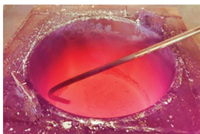
Рис. 4.8.15. Загартування з нагріванням в соляній печі-ванні
