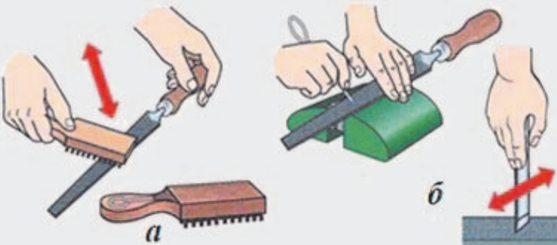
Рис. 1.5.13. Очищення насічки напилків: а — кордовою щіткою; б — скребком з м'якого металу
