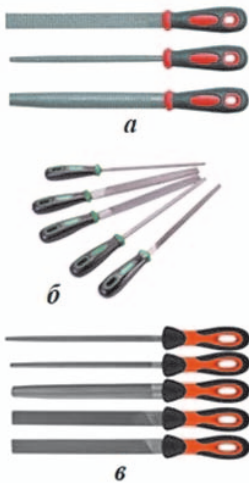
Рис. 1.5.3. Напилки: а — драчеві; б — лицьові; в — оксамитові
