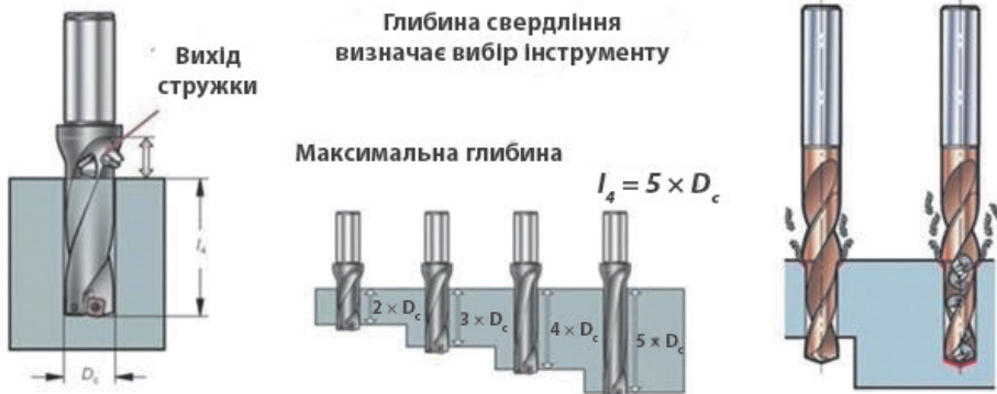
Рис. 1.6.8. Вибір інструменту при свердлінні на глибину
