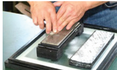
Рис. 1.10.5. Доведення леза рубанка на притирочних брускях
