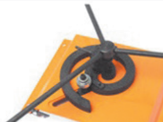
Рис. 1.3.7. Згинання металу квадратного профілю за допомогою обкатного ролика
