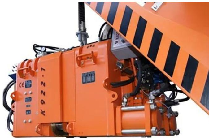
Машина предназначена для контактной сварки в полевых условиях импульсным пламенем рельсов сечением 6500-10000 мм<sup>2</sup> с удалением заусенцев сразу после сварки.
