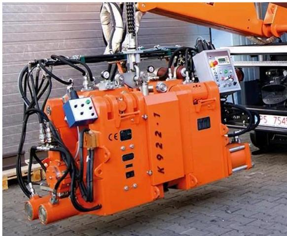
Машина K922-1 имеет более жесткий корпус и увеличенные диаметры поперечного сечения калибровочных штоков и центральной оси, что позволяет развивать повышенное усилие расстропки, дающее возможность сваривать рельсовые струны в пути с затяжкой заусенцев в процессе сварки. Увеличенный ход штоков калибровочных цилиндров исключает операцию перехвата при удалении заусенца, что упрощает технологию сварки и сокращает оперативное время стыковой сварки.
