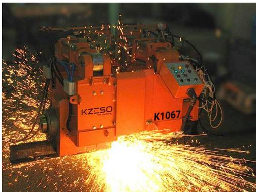
Сварочный аппарат K1067 оснащен более мощными сварочными трансформаторами, что позволяет осуществлять сварку на более жестких режимах - повышенные сварочный ток и сварочное напряжение, реализация импульсного режима вспышки, сокращение времени и пристыковой зоны нагрева рельсов, что обеспечивает качественную сварку рельсов из высоколегированных сталей.
