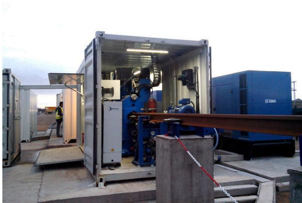
Сварочный комплекс абсолютно автономен: он размещен в трех контейнерах, предназначенных для перевозки автомобильным транспортом, и способен работать в любых климатических условиях, при температуре окружающей среды от +5 до +50 градусов Цельсия.
