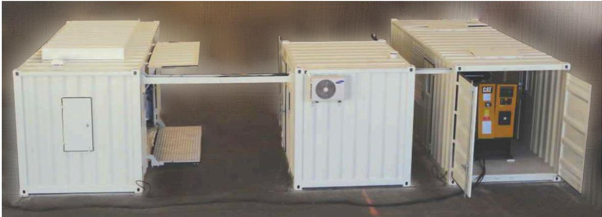
Комплекс предназначен для контактно-стыковой сварки в стационарных условиях с непрерывной или импульсной прошивкой рельсов сечением от 5000 до 10000 мм<sup>2</sup> в рельсовые плети длиной до 1000 метров при строительстве непрерывных (в том числе высокоскоростных) железнодорожных путей с удалением заусенцев сразу после сварки.
