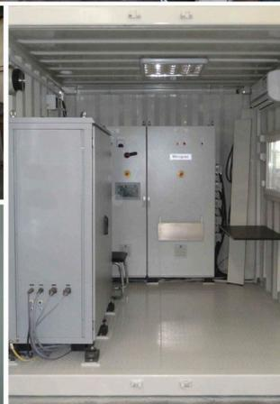
При использовании рельсосварочной машины контейнерного типа K1000 достигается значительная экономия за счет оптимальной доставки рельсов и подачи рельсовых плетей непосредственно к месту укладки рельсового полотна. Автономность и
