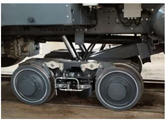
Состоит из рамы транспортного средства, оснащенной железнодорожными осями для железнодорожных путей с шириной колеи, указанной заказчиком.
