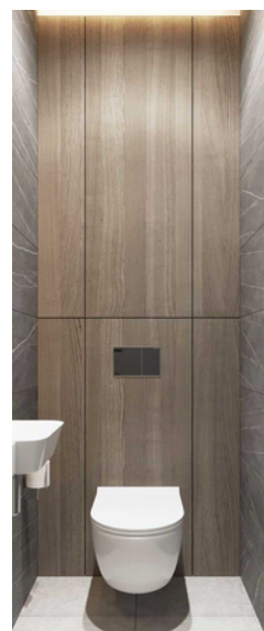
інсталяція та сантехнічний вузол за меблевими панелями для швидкого доступу за потреби
