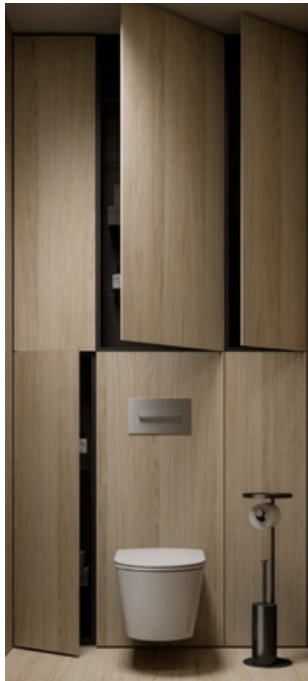
технічна зона за унітазом закрита меблевими щитами
