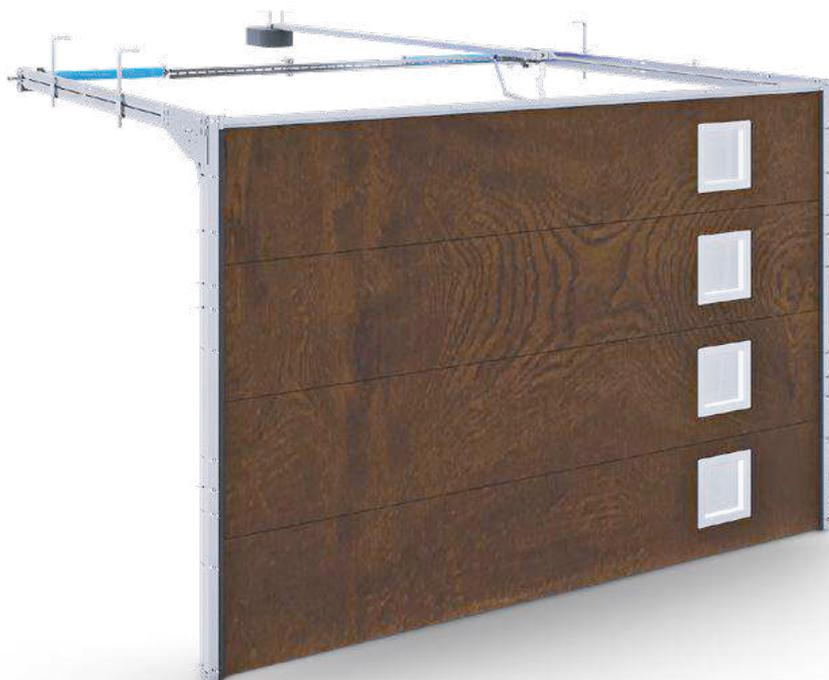
La collocazione delle molle a torsione nella parte posteriore del portone consente di installarlo nell'apertura del garage con una sporgenza inferiore. In questo caso è sufficiente che la sporgenza sia di 85 mm (115 mm per l'alimentazione elettrica) Capacità di carico massima fino a circa 195 kg.
