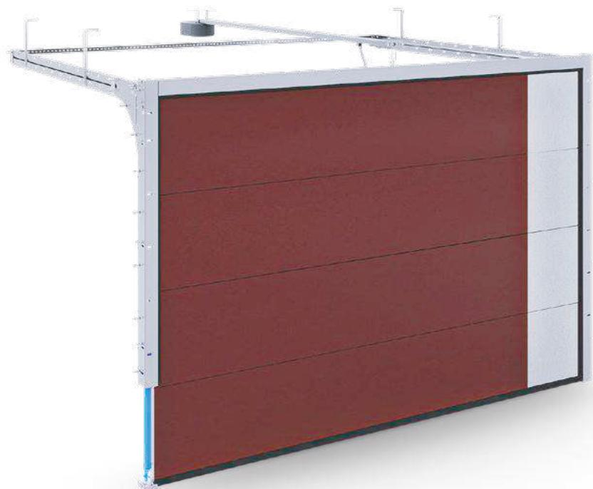
Le molle a trazione sono consigliate per l'installazione in piccoli garage. L'installazione delle porte con molle a trazione è estremamente veloce e non richiede alcun serraggio speciale delle molle. È stato utilizzato un meccanismo a due molle (la cosiddetta "molla nella molla"), che consente di mantenere l'armatura fino a circa 120 kg.
