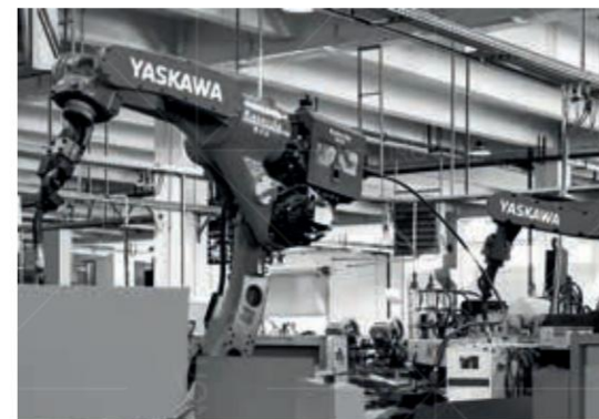
全自动焊接机械臂 Fully automatic welding robot arm
