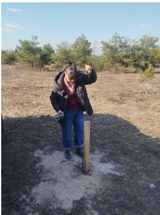
Рис. 2.12. Забір рівня ДГВ гідрогеологічною рулеткою у спостережній свердловині в к.т. 8 станом на 25.03.2026 р.
