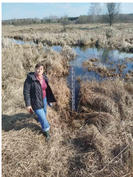
На гідрологічному посту в к.т. 3 спостережний рівень води в р. Білка відповідав нулю графіка даного водомірного поста на абсолютній позначці +157,625м над рівнем моря станом на 06.10.2025р. Станом на 25.03.2026 р. спостережний рівень води в р. Білка піднявся на 0,20 м (рис. 2.5) відносно нуля графіка даного водомірного поста до абсолютної позначки +157,83 м над рівнем моря.
