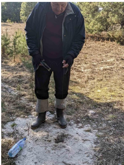
Рис. 2.11. Забір рівня ДГВ гідрогеологічною рулеткою у спостережній свердловині в к.т. 7 станом на 25.03.2026 р.
