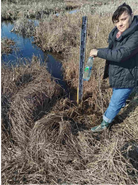
Рис. 2.6. Відбір проби води к.т. 3/3 з р. Білка для хімічного аналізу на гідрологічному пості к.т. 3 станом на 25.03.2026 р.
