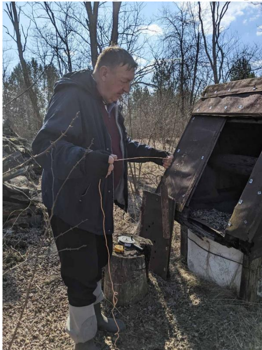
Рис. 2.7. Вимірювання рівня води в занедбаному колодязі к.т. 5/1 станом на 25.03.2026 р.
