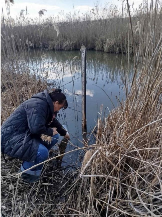
Рис. 2.2. Відбір проби води к.т. 1/3 з р. Білка для хімічного аналізу води на гідрологічному пості к.т. 1 станом на 25.03.2026 р..
