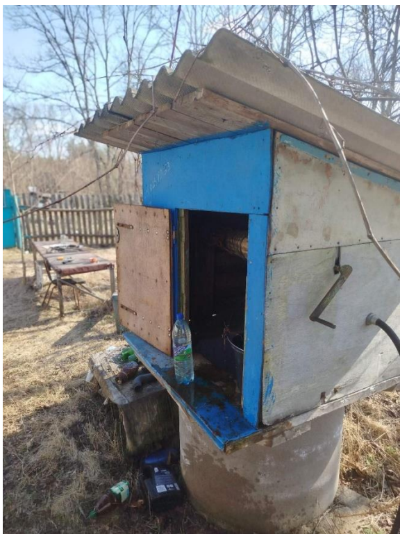
Рис. 2.9. Діючий колодязь в к.т. 5/2 на околиці с. Негребівка, в якому 25.03.2026 р. визначено абс. позн. ДГВ + 164,915 м
