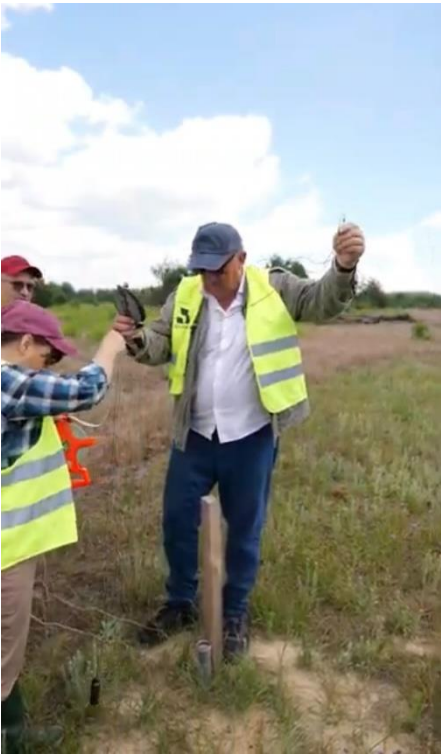
Рис. 2.8. Вимірювання рівня води гідрогеологічною рулеткою у спостережній свердловині № 8
