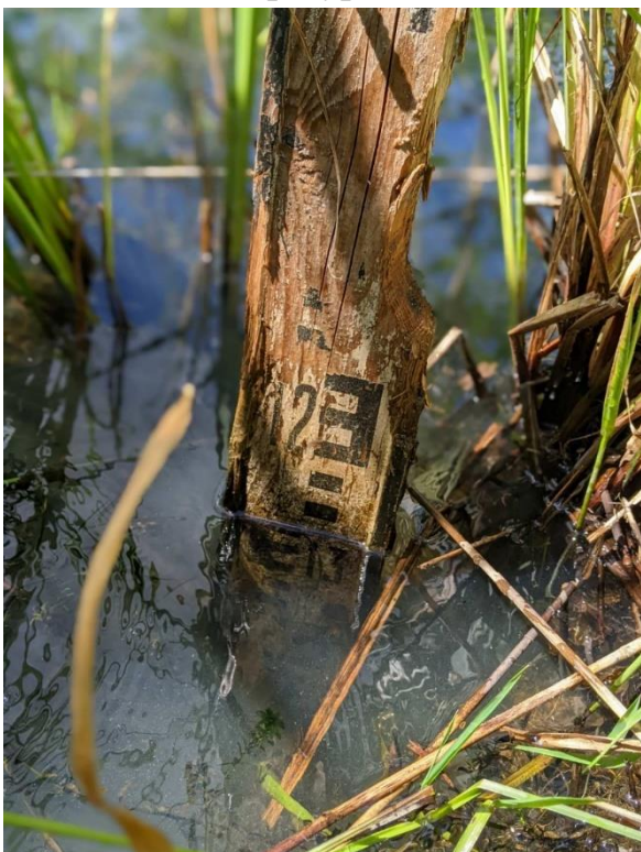
Рис. 2.1. Рівень води в р. Білка на гідрологічному посту в к.т. 1 станом на 29.06.2026 р.
