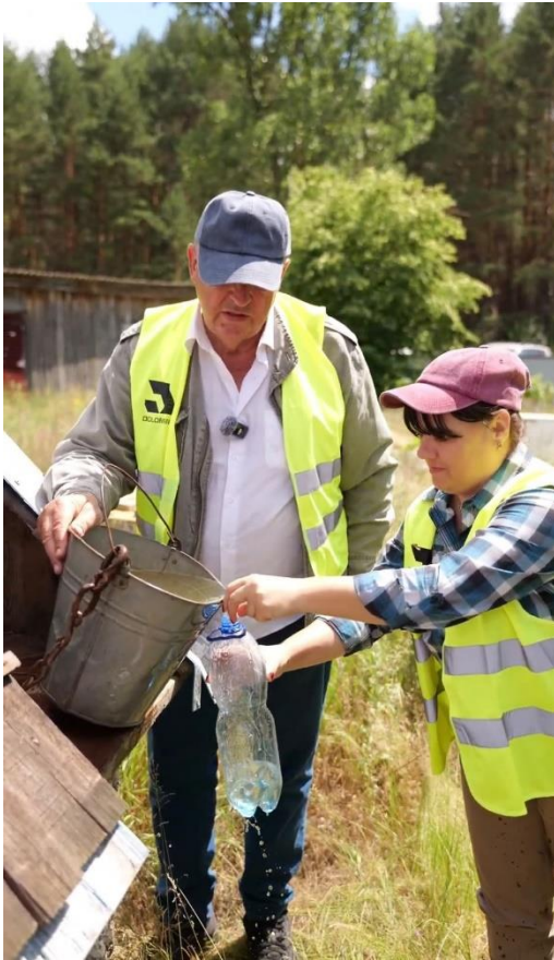
Рис. 2.10. Відбір проби води на хімічний аналіз з колодязя посеред с. Негребівка
