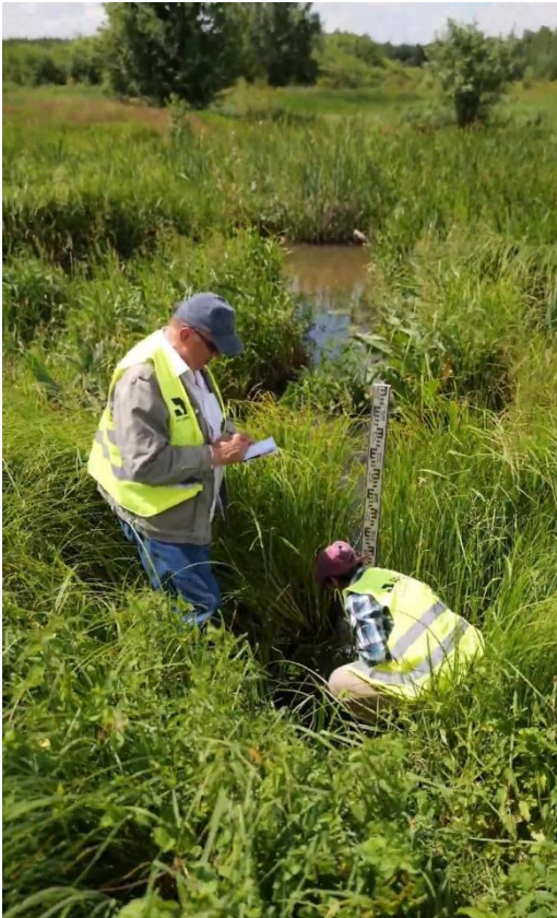
Рис. 2.3. Вимірювання рівня води в р. Білка на гідрологічному посту в к.т. 3 станом на 29.06.2026 р.
