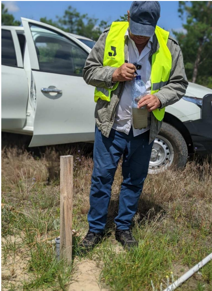
Рис. 2.9. Підбір проби 4/8 підземних вод на хімічний аналіз із свердловини к.т. 8 відбірником желонкового типу станом на 26.06.2026 р.
