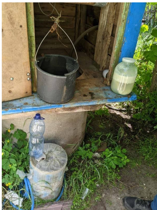
Рис. 2.5. Діючий колодязь в к.т. 5/2 на околиці с. Негребівка, в якому 26.06.2026 р. визначено абс. позн. ДГВ + 164,64 м
