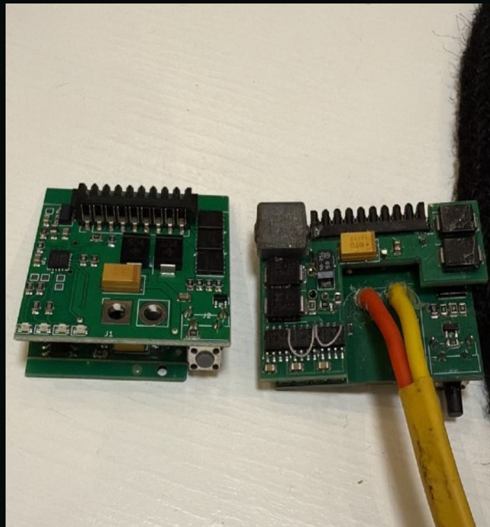
ПЛАТА-КОНТРОЛЕР // ЗАМІНА BMS
